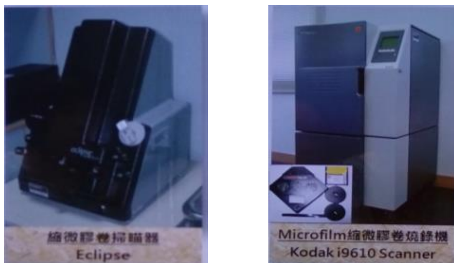
微縮膠捲經由此機器可掃描轉化成一般電子影像，再燒錄成光碟
